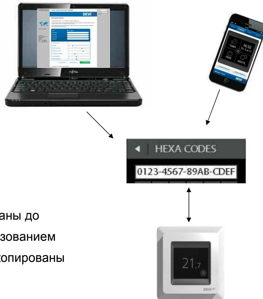
Настройки терморегулятора могут быть заданы до установки и импортированы в него с использованием кода, сгенерированного в Интернете, или скопированы с терморегулятора аналогичной установки
